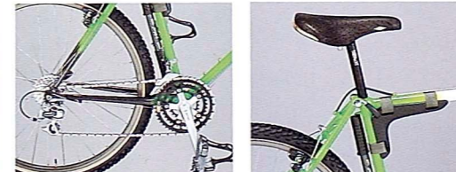
TRANSMISSION 1 ギヤチェンジ チェーンリングブラックアナダイズ処理されたDEORE-XTギヤクラック。高トルク下でも確実に滑らかなギヤチェンジのハイパーグライドフリーを採用。リヤディレラーはチェーンのおどりが少なく高剛性のショートケージ仕様のアッセンブル。
